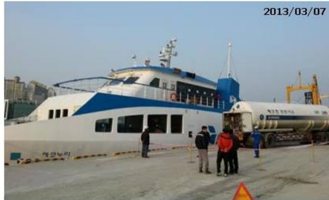
Preparation for LNG Bunkering
